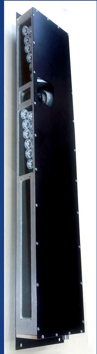
Устройство видеорегистрации ВидеоКадр является функционально законченным устройством, решающим задачу получения изображений в отраженном свете объектов, летящих со скоростью до 2-3 км/с.
